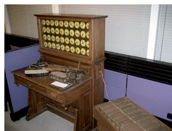
Děroštitkový počítačový stroj pro automatizované zpracování sčítání lidu 1890. Foto: Adam Schuster – Flickr: Proto IBM
